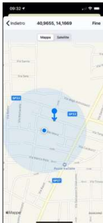
Figura 30: Rilievo automatico coordinate con possibilità di correzione risposto alla propria posizione. Pallino blu posizione operatore – freccia correzione fatta da operatore della posizione
