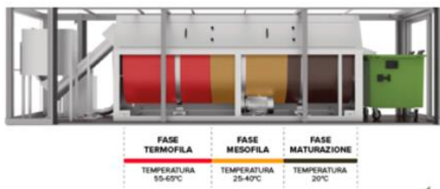
Figura 6 – Fasi di funzionamento dell'impianto di compostaggio
