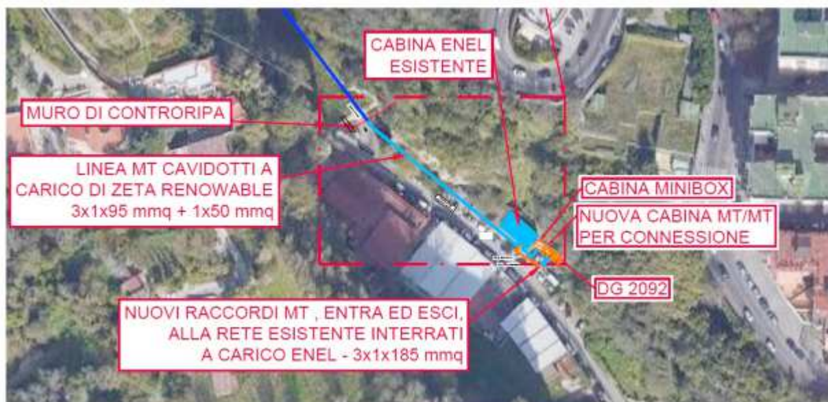
Ubicazione cabina elettrica per il collegamento alla rete elettrica nazionale
