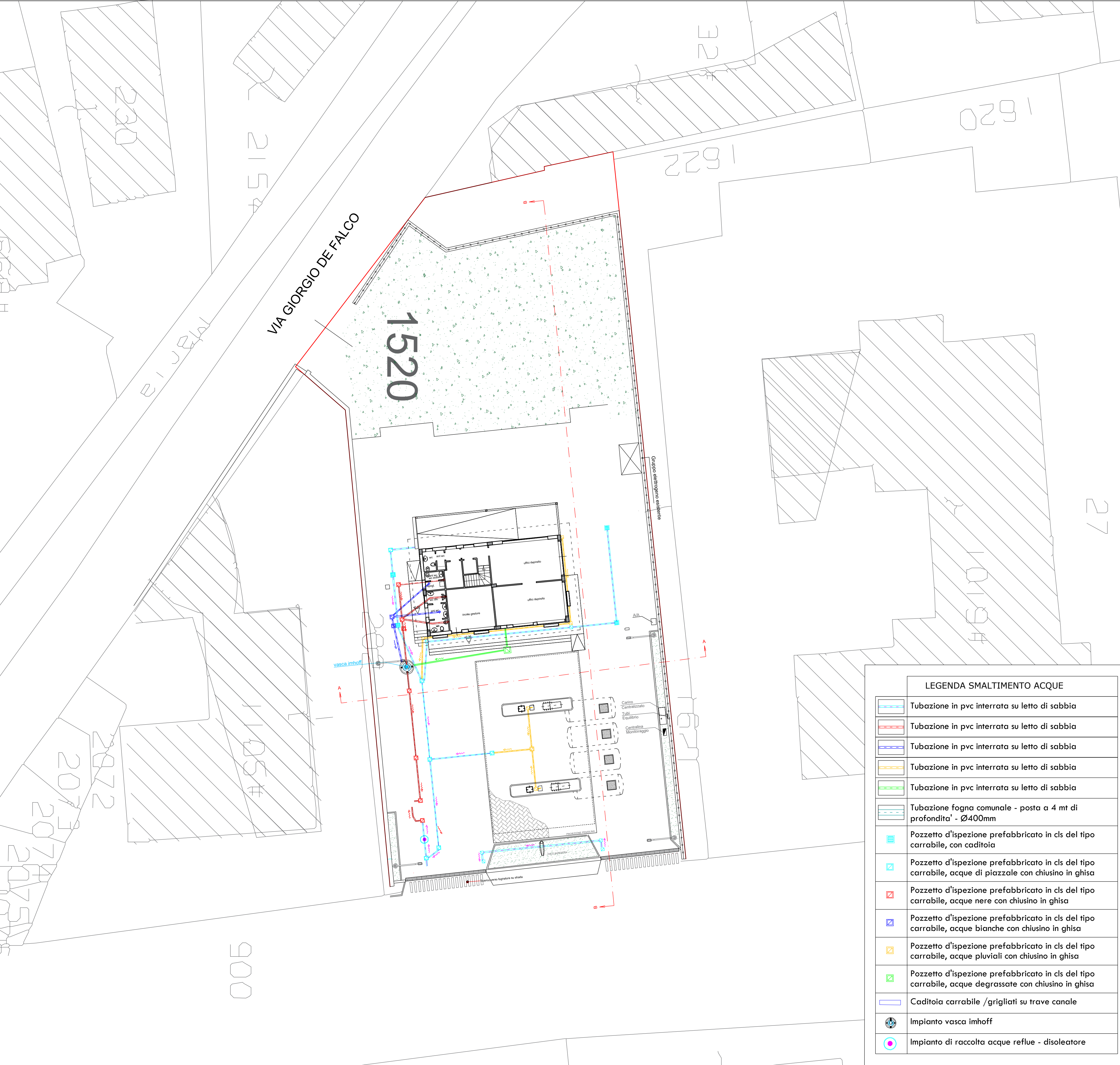
STATO DI FATTO _ PLANIMETRIA GENERALE CON SCHEMA SMALTIMENTO ACQUE ESISTENTE _ SCALA 1:200
