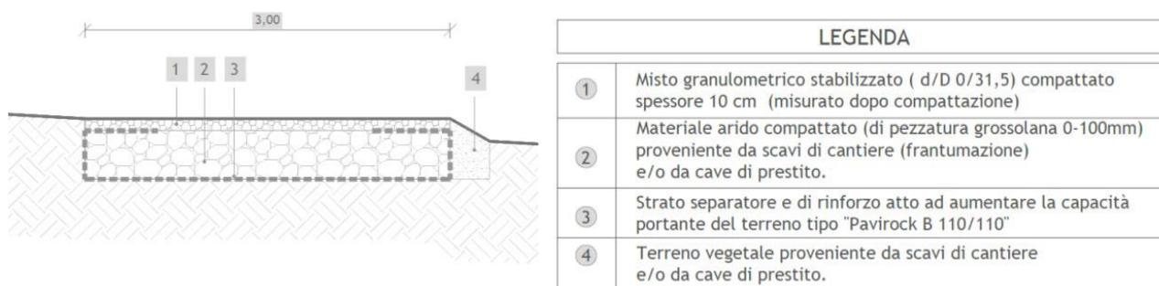
*Figura 7 – Sezione tipica viabilità interna al CF (S.I.A.)*
