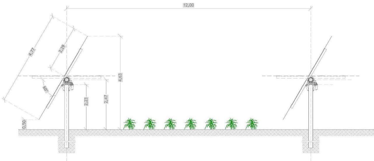
*Figura 6 – Possibile configurazione dell'agro-voltaico (S.I.A.)*
