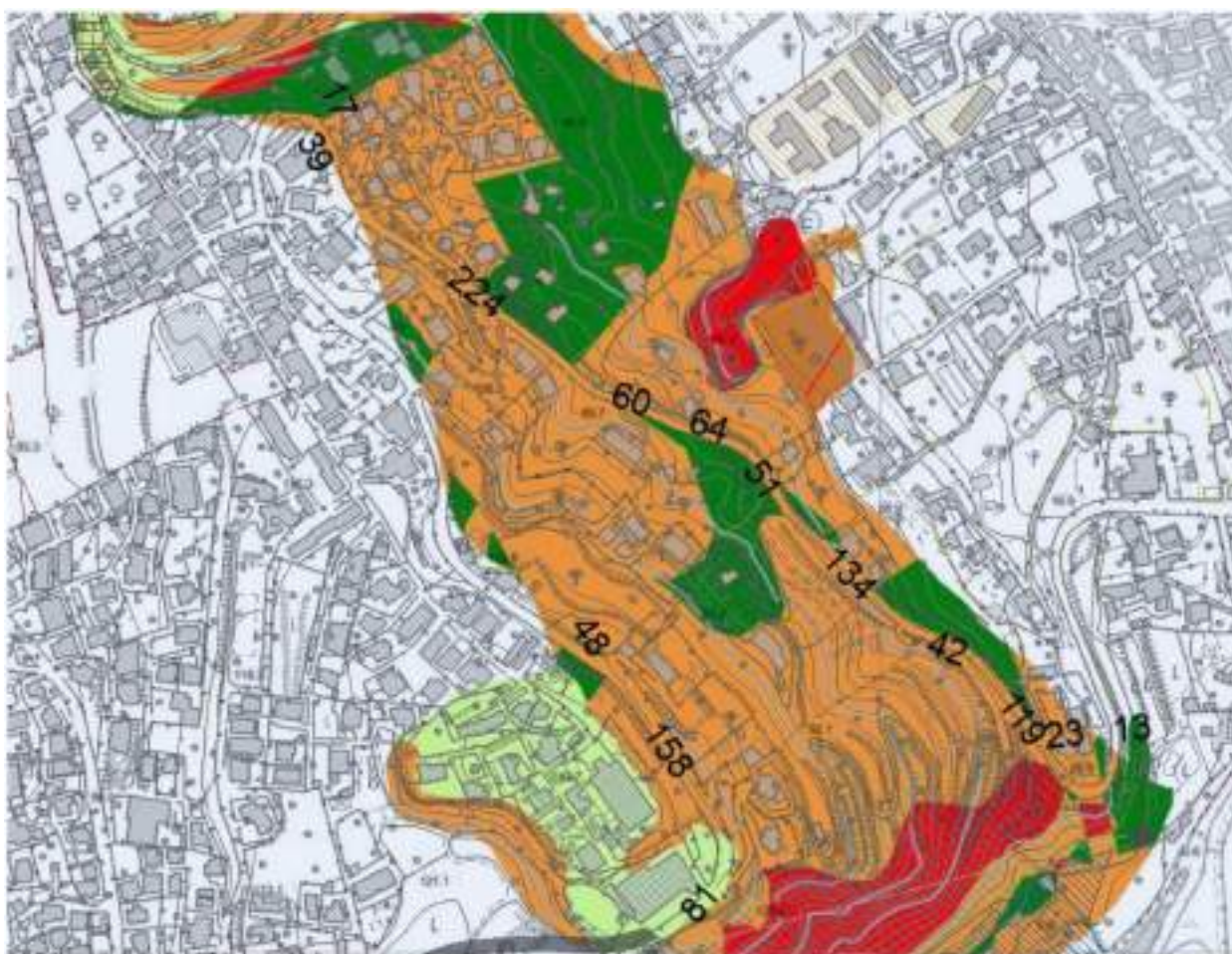
Fig 5 – R3 - ml di tratto da consolidare (da considerarsi doppiato a monte ed a valle laddove esteso al lato monte)
