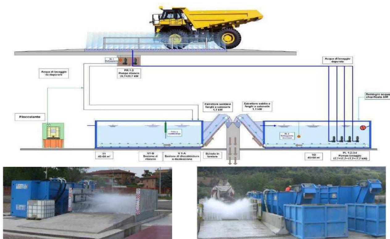
**Figura 13 - Schema tipo impianto di lavaggio a bassa pressione con ricircolo acqua**
