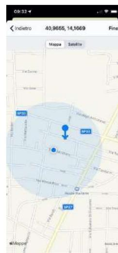
**Figura 6:** Rilievo automatico coordinate con possibilità di correzione risposto alla propria posizione. Pallino blu posizione operatore – freccia correzione fatta da operatore della posizione
