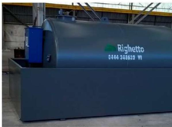
Il contenitore è un distributore mobile omologato dalla capacità di litri 9000, senza gruppo erogatore, con bacino di contenimento di capacità pari al serbatoio stesso aumentato del 10%.
