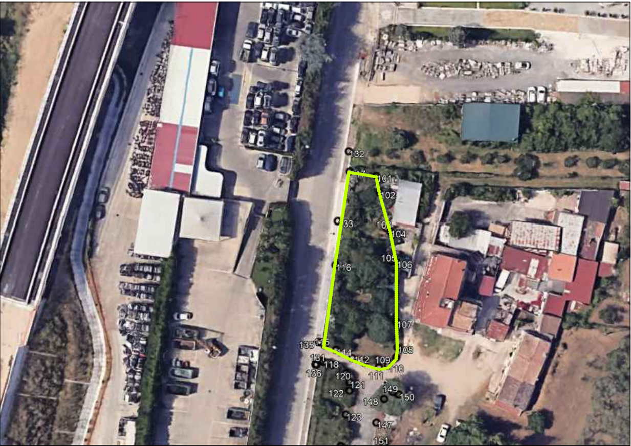
SOVRAPPOSIZIONE SPEDITIVA DEL RILIEVO PLANO-ALTIMETRICO ALL'ORTOFOTO TRATTA DA GOOGLE EARTH CON INDICAZIONE DEI MARGINI DEL LOTTO DI INTERESSE
