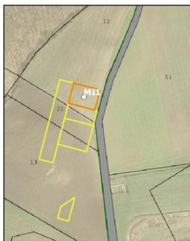
Piazzola di esercizio (in arancione) e piazzole temporanee (in giallo), relative all'aerogeneratore M11, su catastale e immagine satellitare (Fonte: Cartografia catastale Agenzia dell'Entrate 2023 - Google earth Pro)
