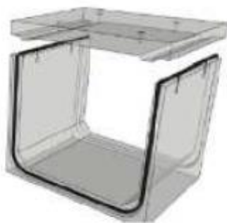
Allegato GEN_02 Figura 22 – Manufatto scatolare tratto D-1
