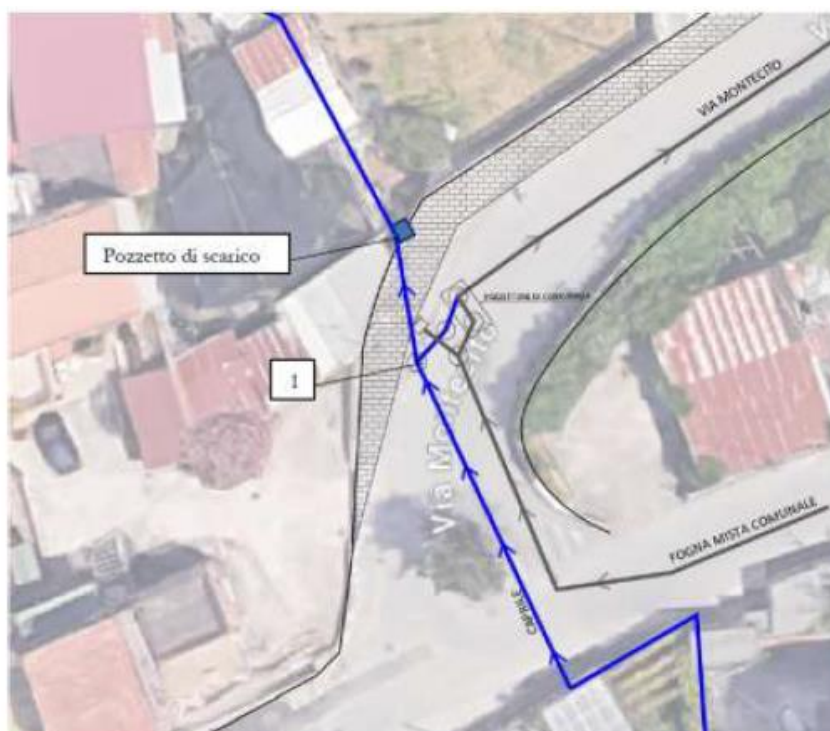
Figura 28 - schema delle confluenze tra Caprile e fognatura comunale in Via Montecito
