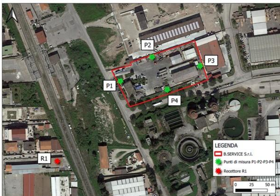
Figura 6: Ortofoto con indicazione dei recettori e dei punti di valutazione delle emissioni sonore
