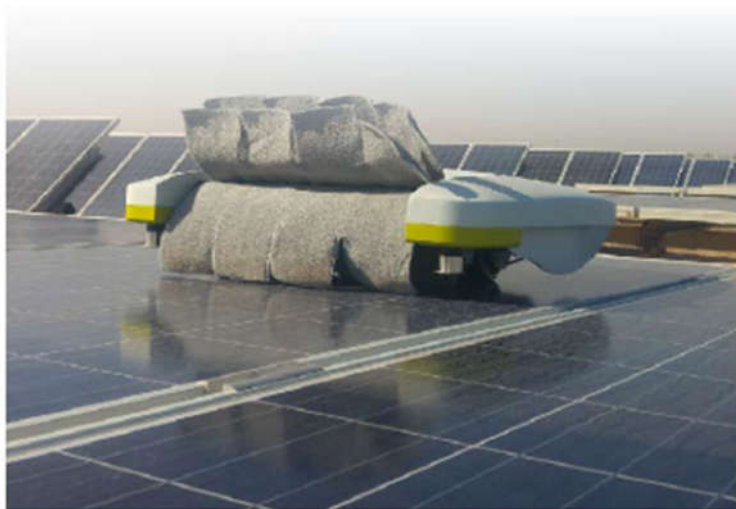
Figura 11 –robot per pulizia moduli fotovoltaici
