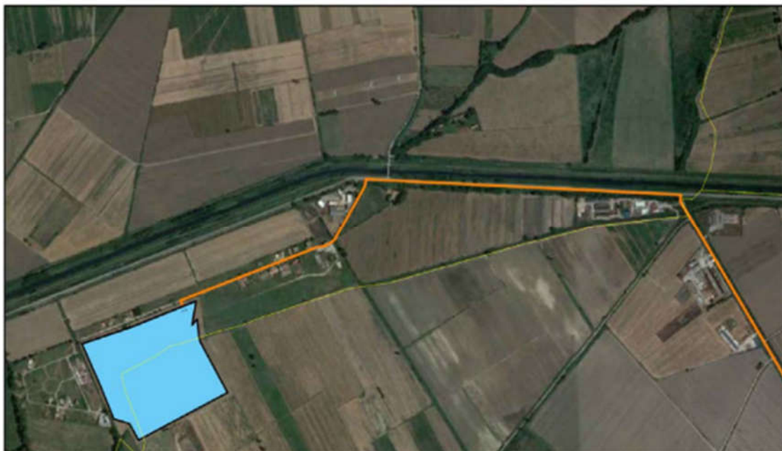
Figura 8 – posa del cavidotto – risoluzione interferenza con il canale Agnena
