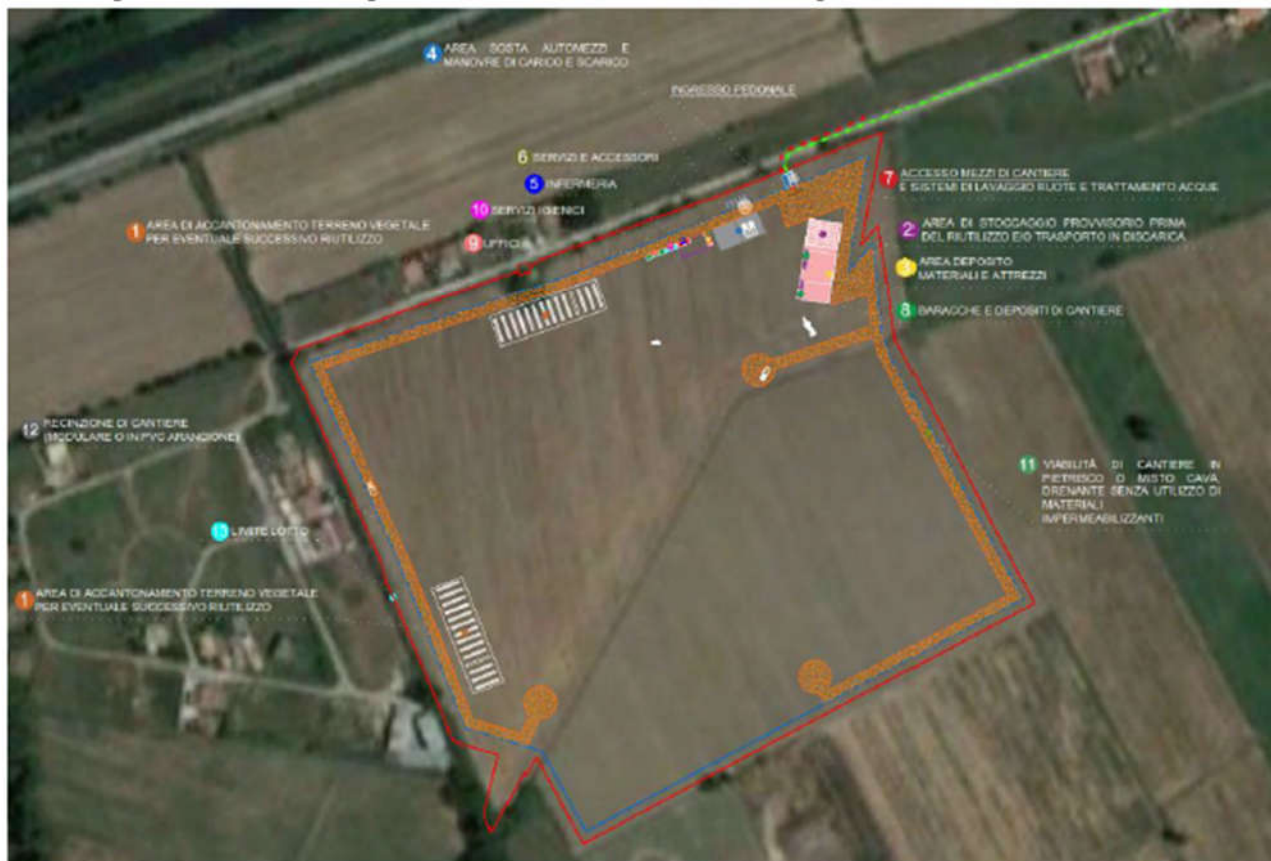
Figura 14 – layout di cantiere
