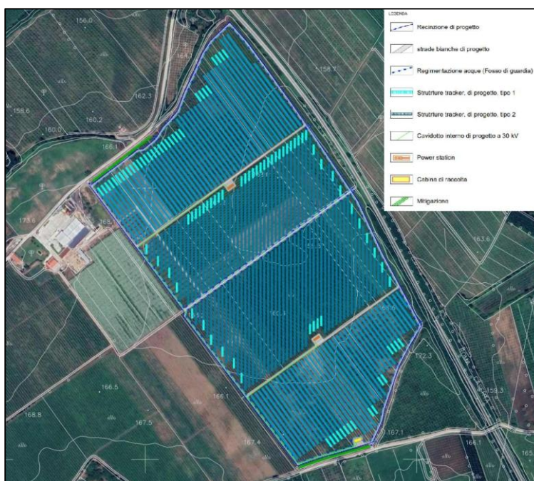
Figura 69 – Regimentazione delle acque meteoriche
