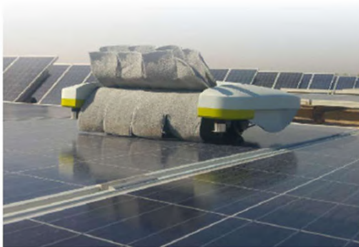
Figura 11 –robot per pulizia moduli fotovoltaici
