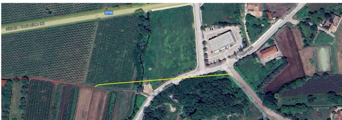
Figura 127 - interferenza con corso d'acqua e strada pubblica non interessabile al km 1.930 circa del cavidotto MT esterno.
