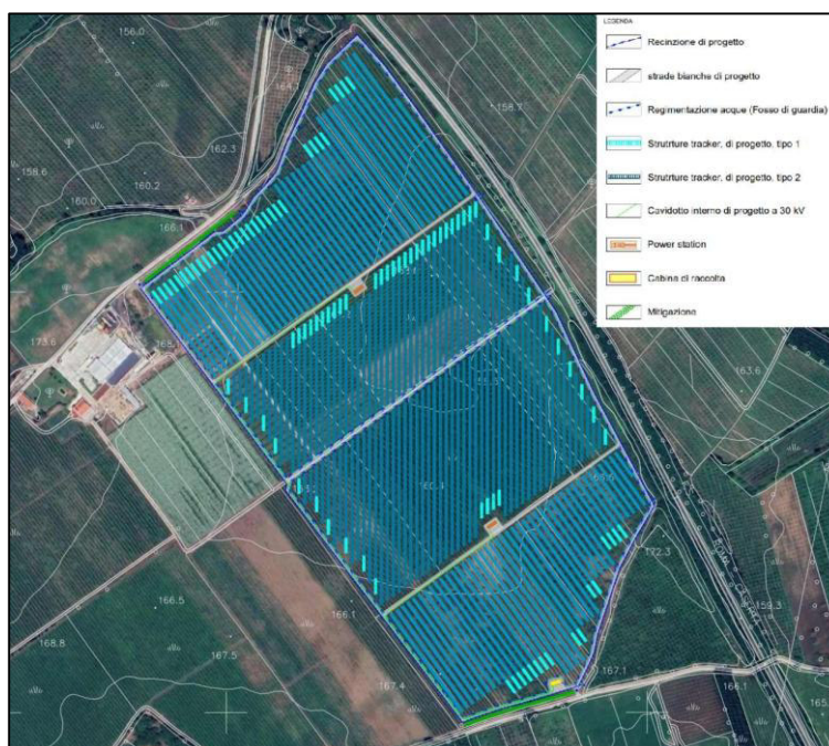
Figura 69 – Regimentazione delle acque meteoriche
