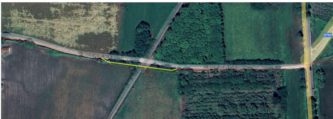
Figura 126 - interferenza con linea ferroviaria a raso al km 1.115 circa del cavidotto MT esterno. Risoluzione in TOC
