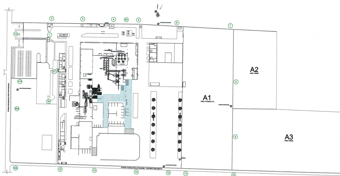
Figura C.1 Individuazione punti di misurazione delle emissioni sonore
