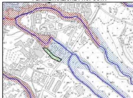
In ragione dei risultati ottenuti, viene proposta la riclassificazione delle aree a valle della Panoramica Turci ed in sinistra idraulica del tracciato "effettivo" del corso d'acqua a pericolosità bassa (P1).
